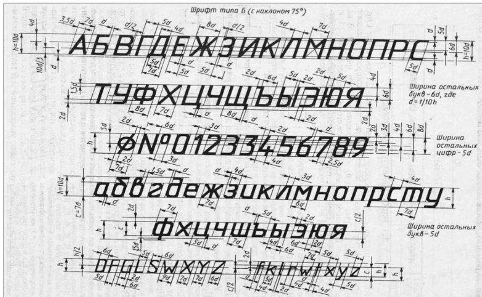
Рисунок 2 – Шрифт типа Б с наклоном около 75^\circ
